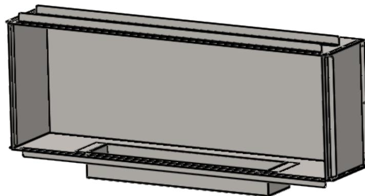
struttura spessore 1,2 mm
